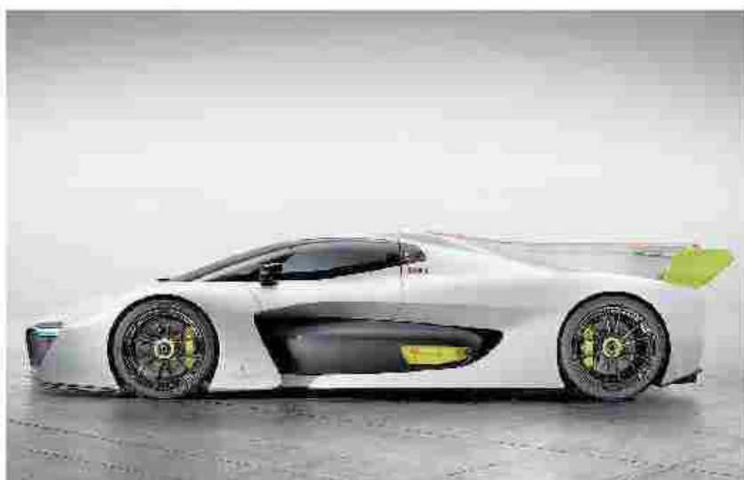
Pininfarina h2 speed La vettura sviluppata con l'azienda GreenGT è fornita di due motori elettrici ed eroga 503 CV
